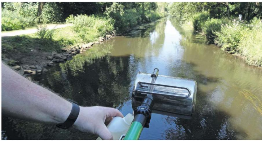
Probe wird entnommen: Lars Jurzik füllt an der Ems-Fußgängerbrücke mit einem speziellen Schöpfergerät Wasser in eine sterile Probeflasche.
